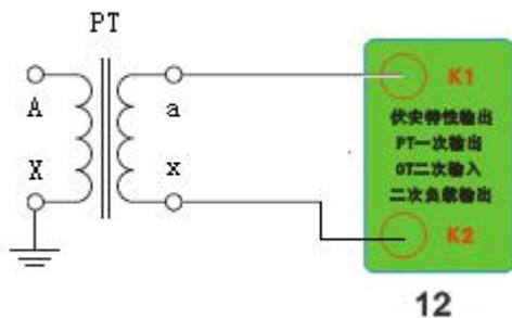
5. 接线图：图五 (PT 变比接线图)
