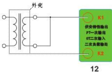
7. 接线图：图七 (二次直阻接线图)
