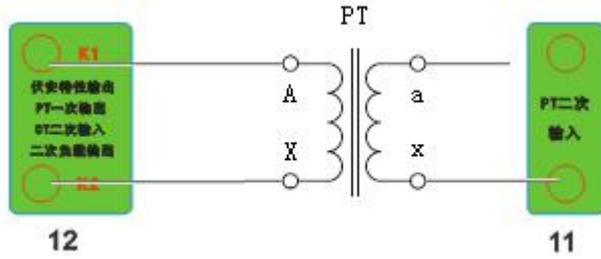
6. 接线图：图六 (二次耐压接线图)
